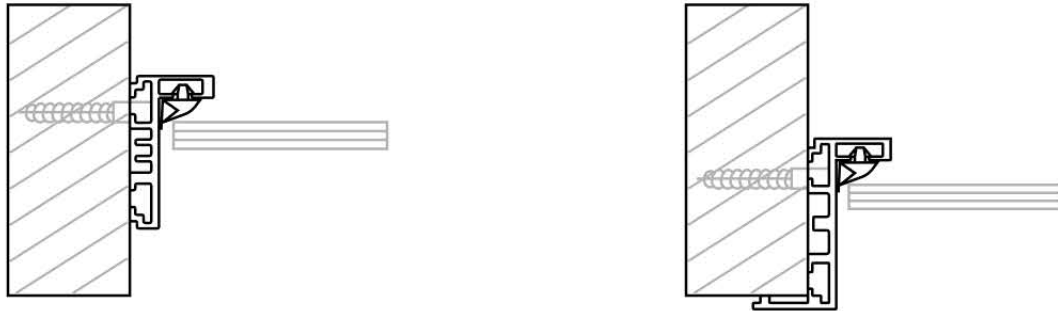
Рисунок 3 – Узел установки коробки в проём
